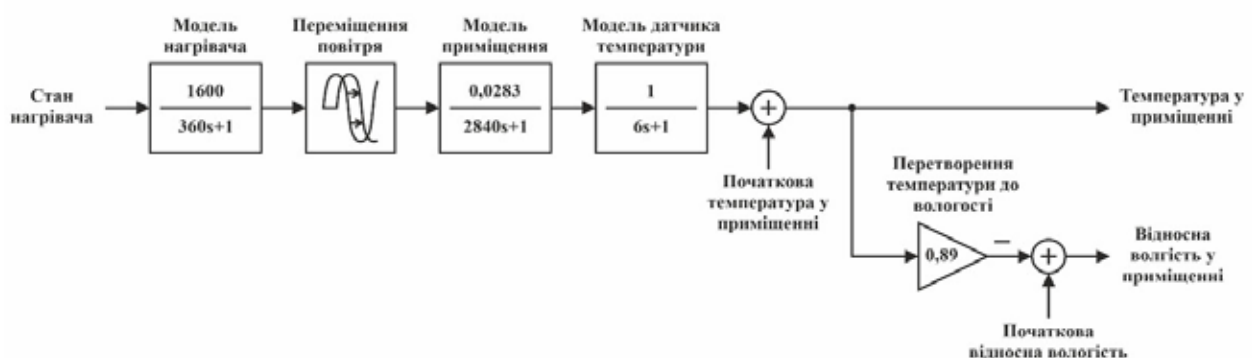
Рис. 1. Структурна схема удосконаленої моделі приміщення для дослідження процесу керування тепловим комфортом
