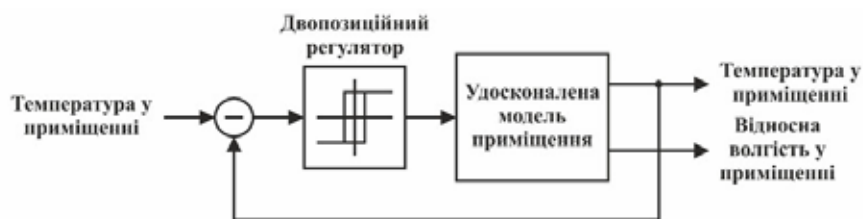
Рис. 3. Структурна схема моделі системи керування температурою у приміщенні на базі двопозиційного регулятора
