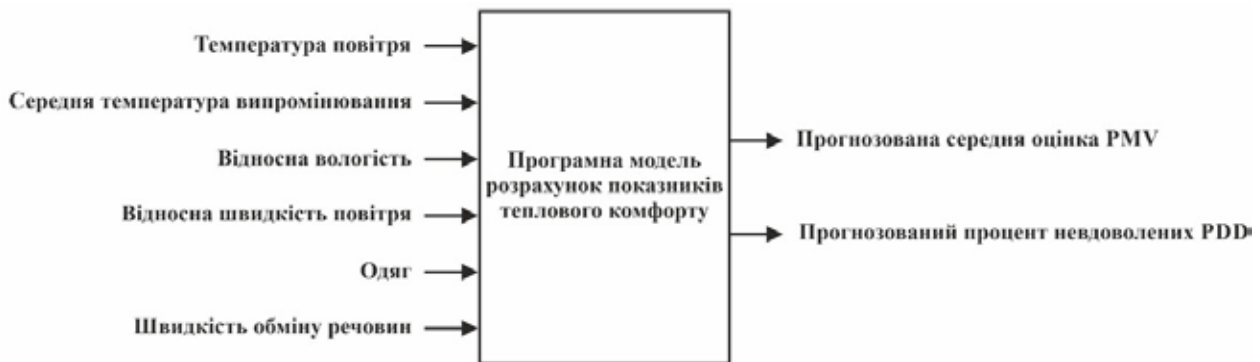
Рис. 2. Вхідні та вихідні параметри програмної моделі розрахунку параметрів теплового комфорту
