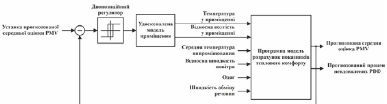
Рис. 4. Структурна схема моделі системи керування тепловим комфортом у приміщенні на базі двопозиційного регулятора
